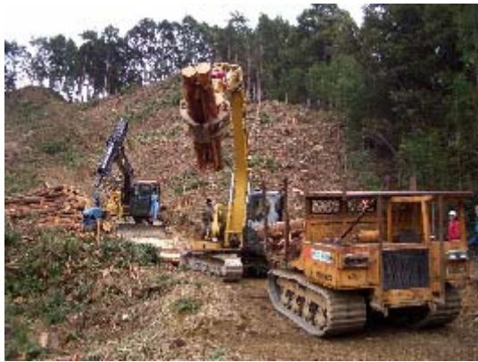
新森林作業システムオペレータ研修 プロセッサ（奥）で造材し、グラップル ローダ（中）で木材をフォワーダ（手前）に 積んで運搬する
